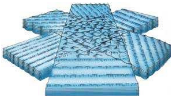
► Valurile interne de interfața între două straturi de apă de diferite densități. Una dintre ele este densă (cea inferioară), iar cealaltă parte este mai puțin densă (cea superioară).
