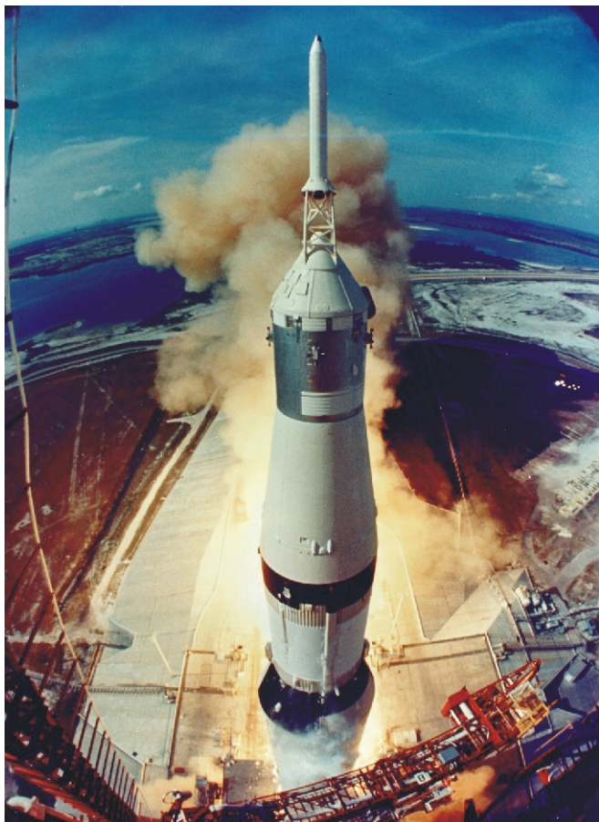
Fig. 28 Imagine a rachetei Saturn 5, „puterea” cu ajutorul căreia omul a traversat ținuturile cerurilor și a trecut de pe platoul Pământului pe platoul Lunii. Ea are lungimea de 24 de metri, lățimea de 7 metri; conține 123 de kilometri de fire electrice, are o forță de împingere de 3400 de tone și consumă 15 tone de kerosen pe secundă în momentul lansării.
