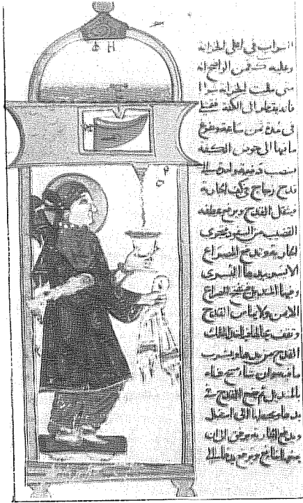
صورة من مخطوط يبحث في علم الطبيعة ( الفيزياء والحيل الهندسية ) للجزري والرسم بين جهازا ذاتي الحركة لتقديم الشراب .. والمخطوط يحمل عنوان ( كتاب في معرفة الحيل الهندسية ) .
