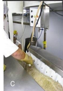
شكل (14): أدوات كهربائية لصعق الأغنام
