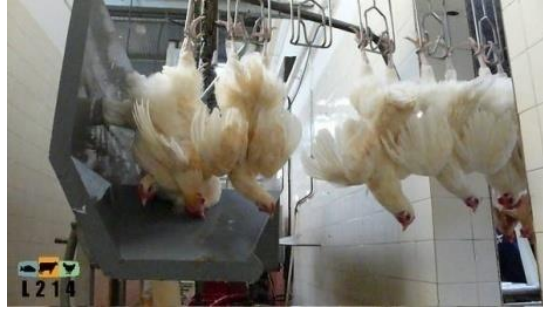
شكل (13): الصعق بواسطة المغطس المائي المكهرب
